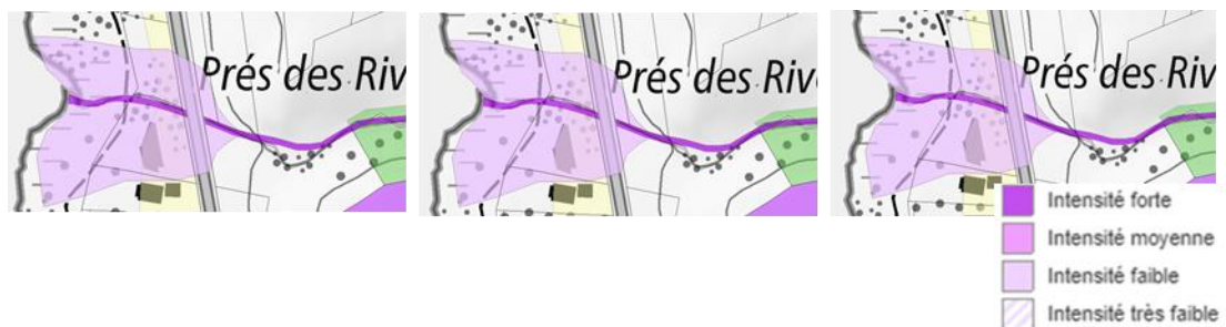
Figure 14: Carte des intensités pour les temps de retour 30 ans (gauche), 100 ans (milieu) et 300 ans (droite)
